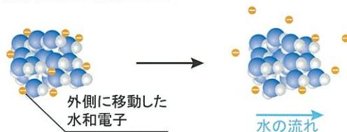
5 放電による水和電子は、新規の鉄の酸化反応による赤錆の発生を防止すると共に、既にある赤錆を黒錆に還元します。(図⑤)
