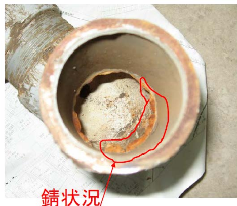
図-6 S55 年度布設の撤去管-VLGP (参考)
